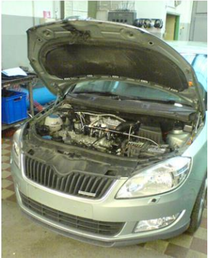
Vodíkový motor instalovaný do vozu Škoda Fabia
