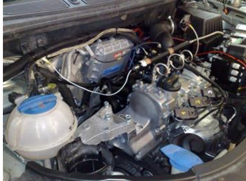
Vodíkový motor instalovaný do vozu Škoda Fabia
